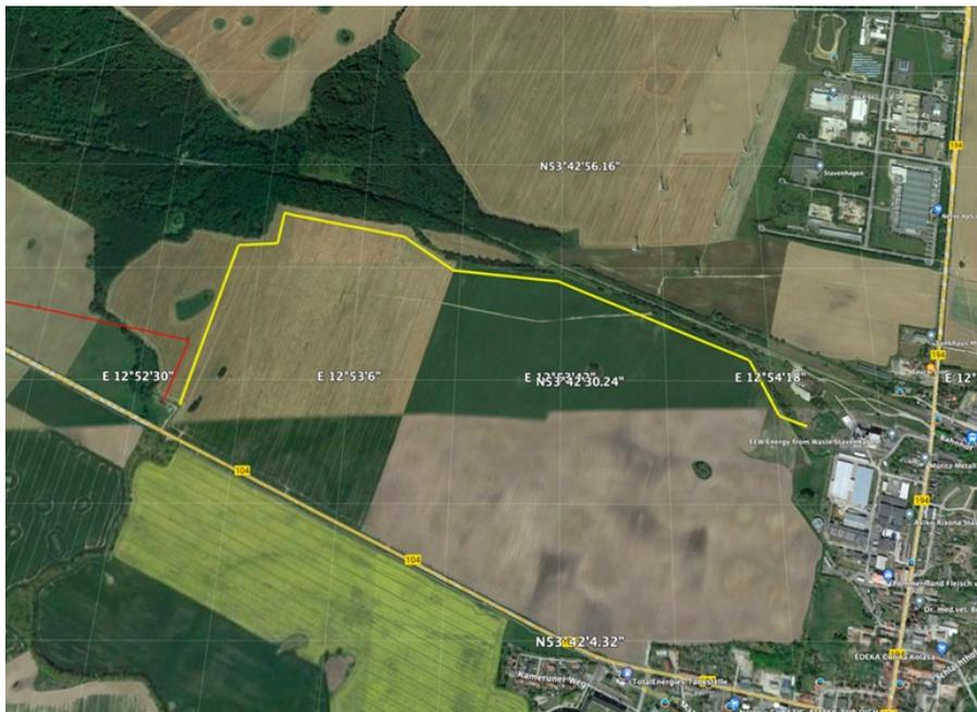
Das Grundstück der EEW Stavenhagen liegt in ca. 1 km Entfernung (Luftlinie) vom Umspannwerk der E.DIS an der B104 westlich von Stavenhagen. Es ist geplant von dort eine Leitung zur Versorgung der 20 MW-Elektrolyse mit grünem Strom zu verlegen (gelbe Linie). Derzeit werden durch East Energy die entsprechenden Flächen gesichert (Leitungsrechte). Die Trasse im westlichen und nördlichen Bereich der Ackerflächen ist ca. 2,7 km lang.
