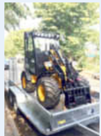
Wendig und klein für enge Baustellen - der Kompakt-Radlader
